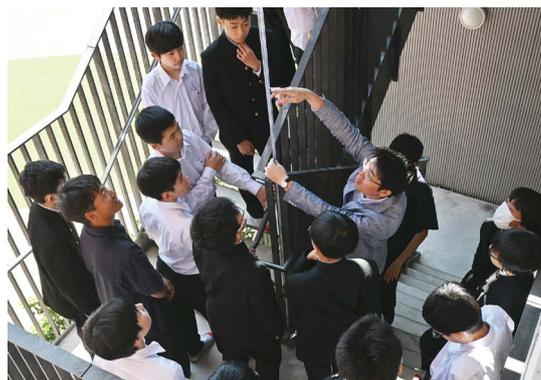
サイエンスセンターの外階段を使って、チューブ内の水の高さで大気圧を測る実験をする中学2年の理科II(地学)の授業
